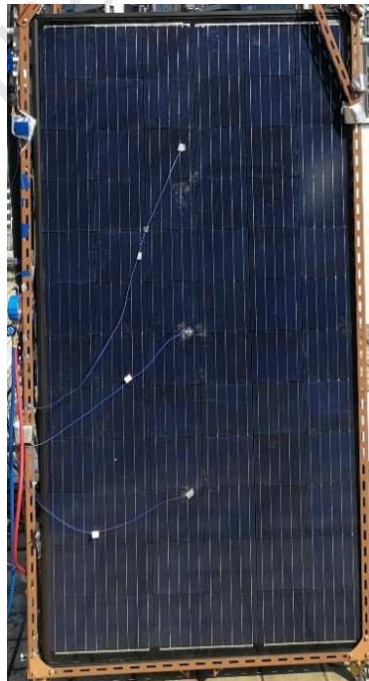
Fig. 9. Actual setup of the LHP- PV/T collector.
