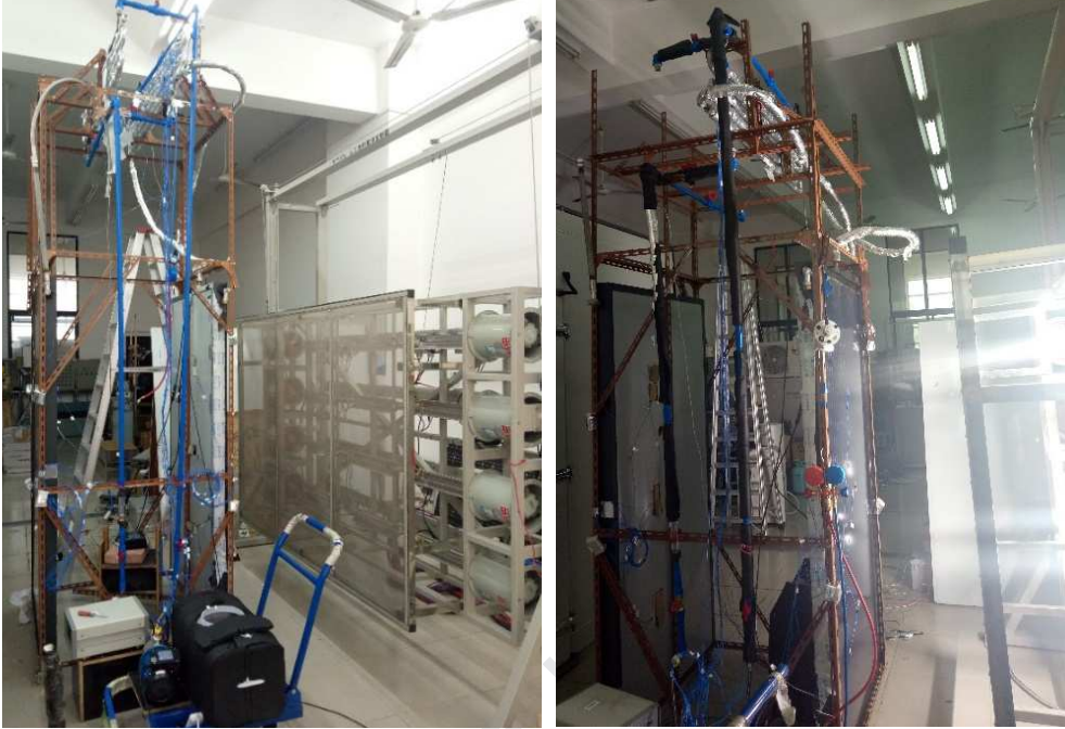
Fig. 8. Actual setup of the LHP- PV/T system test rig.
