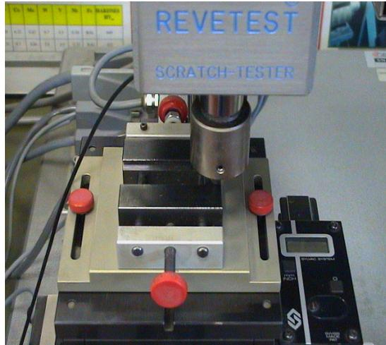
**Fig. 31** - Detail of scratch tester (Centro Sviluppo Materiali S.p.A.)
