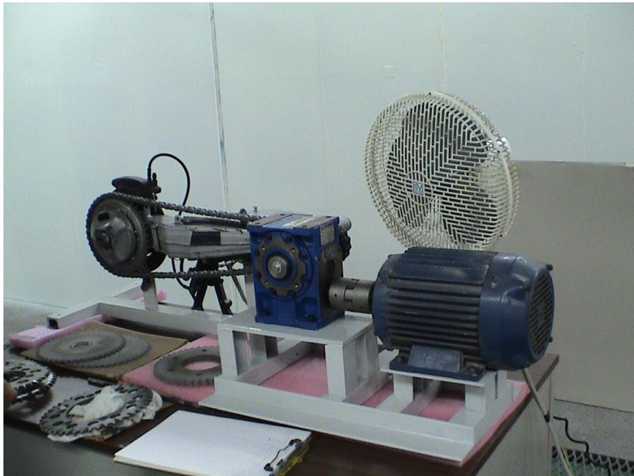
**Fig. 98** –Test-bench for sprockets
