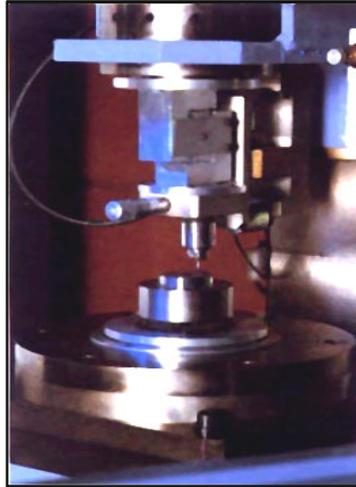
**Fig. 33** – RTM pin-on-disk apparatus (Centro Sviluppo Materiali S.p.A.)
