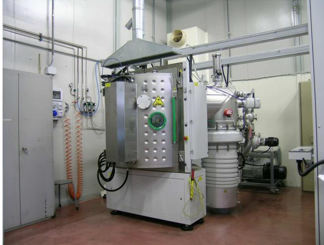
**Fig. 29** - Microcoat MA 1100 PVD apparatus (Centro Sviluppo Materiali S.p.A.)
