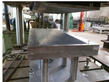
(d) Pressing mould in position
