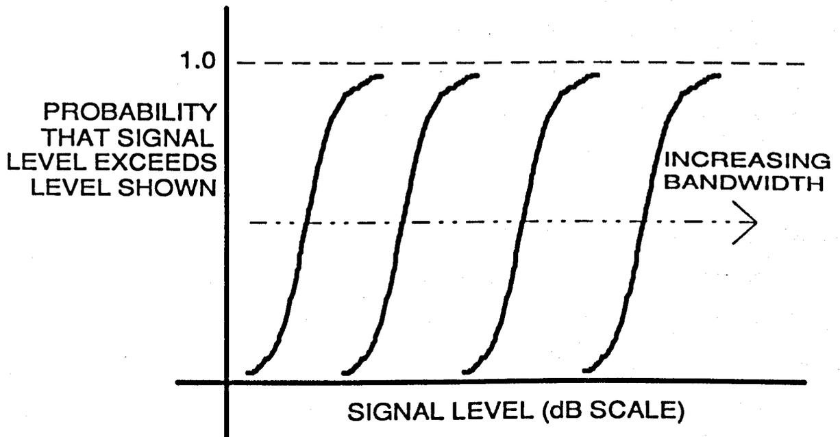
**FIGURE 3.6. MODEL FOR OCCUPANCY OF 3 kHz BANDWIDTH CHANNEL**
