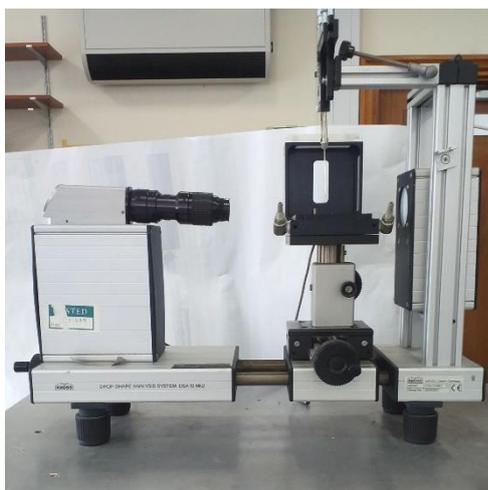
**Figure 2.3** Drop Shape Analyser (DSA 10 Mk2).
